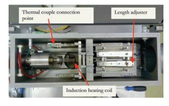
Figure 3-DIL 805 Bähr Thermo Analyser, quench dilatometer
